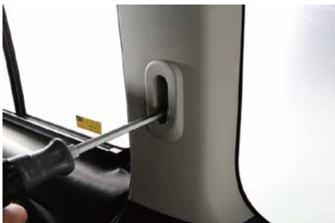
マット固定用ベルトの取付け (シートリア 3 点式シートベルト非装着車)
