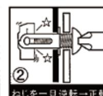
手回しドライバーでねじを押しながら1~2回逆転(左回し)し、そのまますぐに2~3正転(右回し)して、ねじを軽くねじ込みます。
