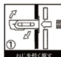
ターンナットを下穴に挿入した後、器材を当てかいねじを指で差し込みます。ねじを軽く押すと、ナットが回転します。
